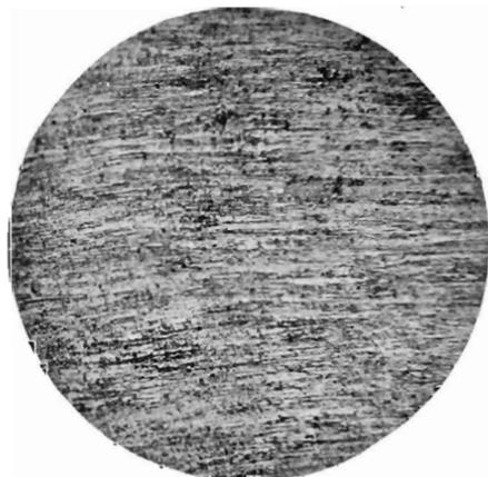
FIG. 4.—SWAGED TUNGSTEN ROD,
