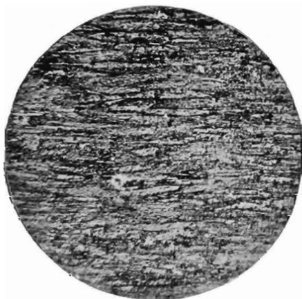
FIG. 3.—SWAGED TUNGSTEN ROD, 0.125 IN. DIAM.  $\times 152$ .
